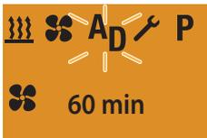
Anzeige bei Luftheizgeräten im Dauerbetrieb LÜFTEN (Werkseinstellung).
