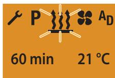
Anzeige bei Luftheizgeräten im Dauerheizbetrieb (Werkseinstellung).
