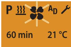
Anzeige bei Luftheizgeräten im Dauerbetrieb LÜFTEN.
