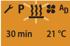
Anzeige bei Luftheizgeräten im Dauerheizbetrieb (Werkseinstellung).
