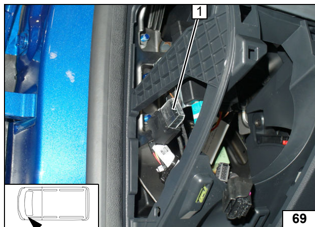
1 Sicherung Bedienelement F1 1 A
